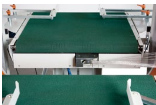
全自動フィルムホッキングシステム フィルムのホッキング、カット、ホルディング、 まですべて自動で行えます。
